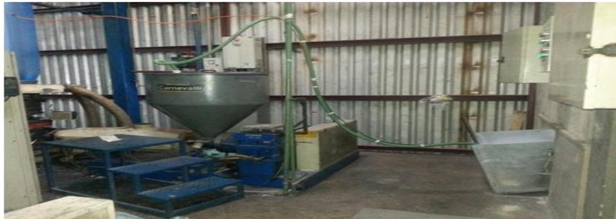
Figura 7.6 Alimentación directa desde el tanque inclinado hasta extrusora
