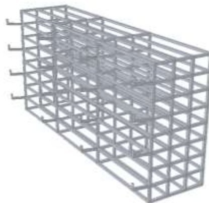
FIGURA 3.17 ESTRUCTURA DE SOPORTE PARA TUBOS
