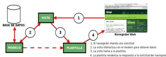
Figura 5. El patrón de diseño MVT.
