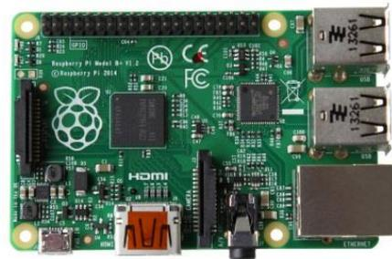
Figura 11. Placa Raspberry Pi B+.
