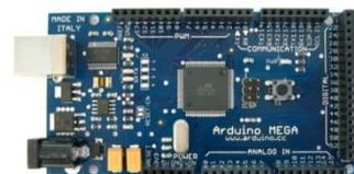
Figura 8. Tarjeta electrónica Programable Arduino Mega.
