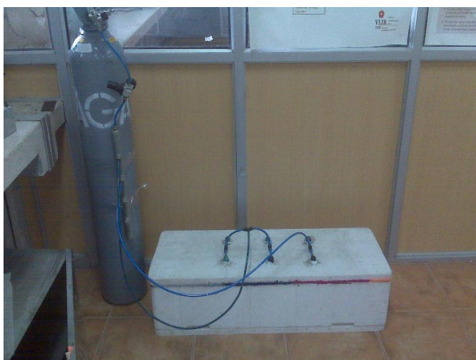
Fig. 2.22 Diseño Final de cámaras de carbonatación
