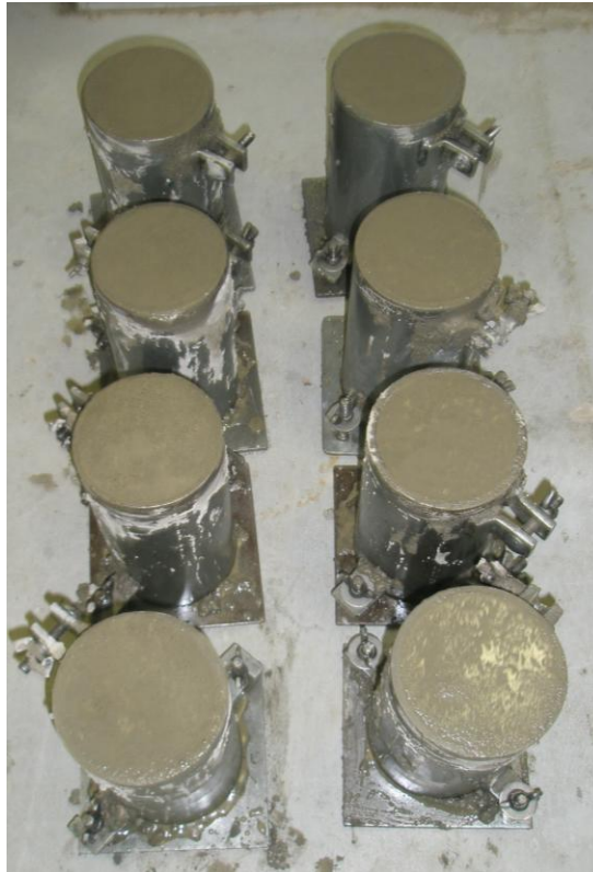
Fig. 2.2 Mezcla de concreto en moldes cilíndricos
