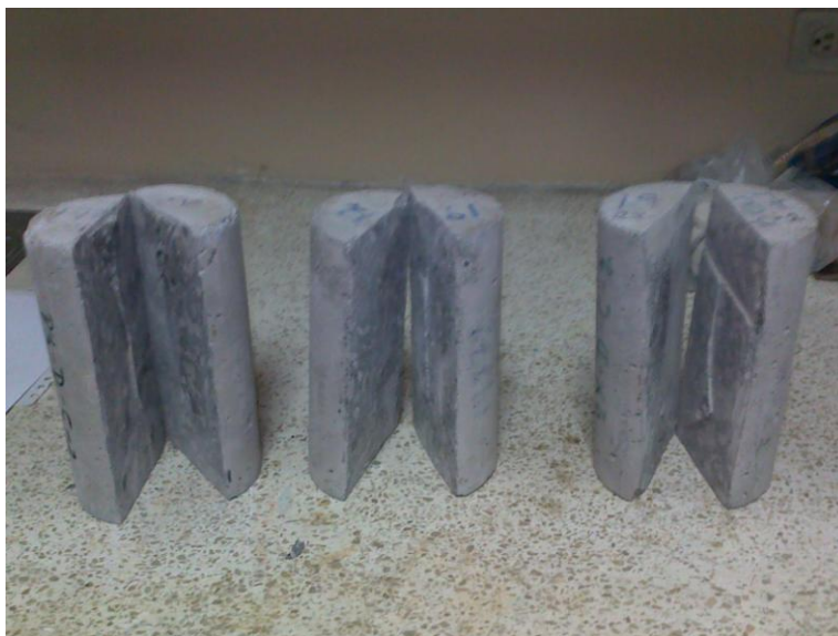
Fig. 2.24 Corte longitudinal de las probetas carbonatadas
