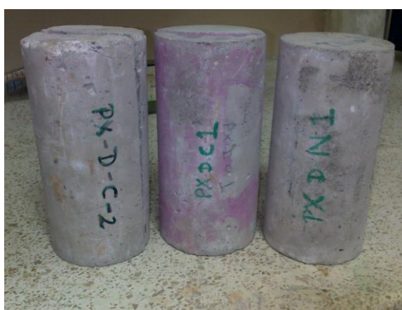
Fig. 2.23 Probetas retiradas de cámara de carbonatación
