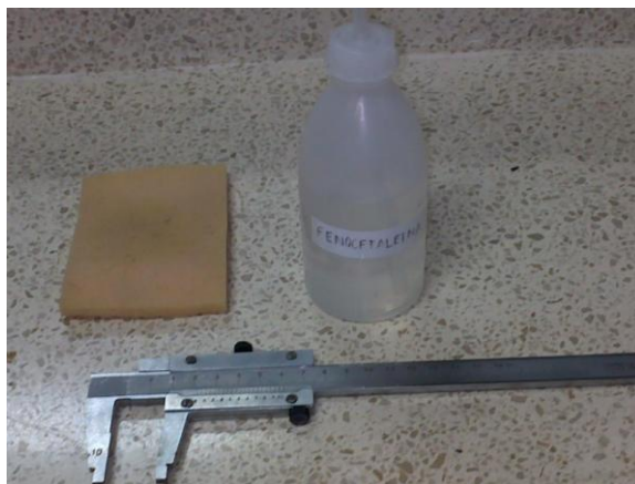
Fig. 2.25 Elementos utilizados para instrumentación de carbonatación
