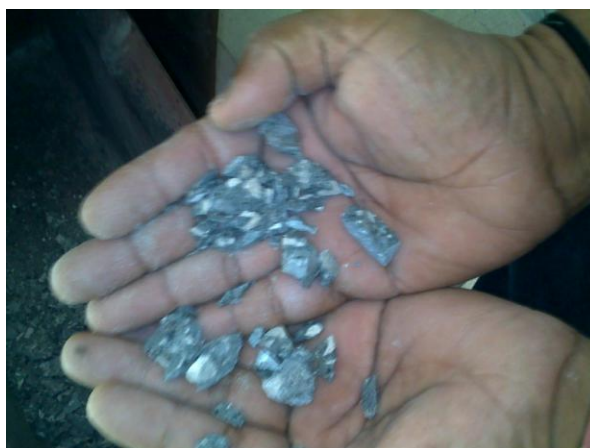
Fig. 2.15 Probeta triturada en molino de mandíbulas
