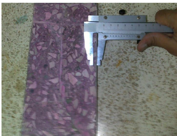
Fig. 2.26 Lectura de la medida del frente carbonatado
