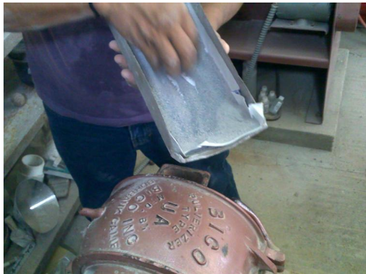
Fig. 2.19 Probeta triturada en discos
