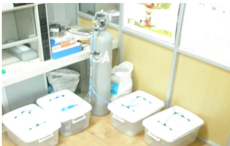
Fig. 2.21 Diseño inicial de cámaras de carbonatación
