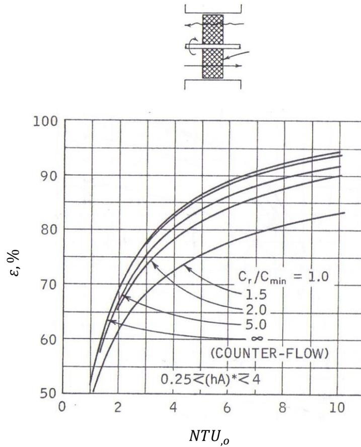
Figura 2.4. Efectividad de transferencia de calor en función del Número de Unidades de Transferencia y capacidad térmica de la matriz para  $C_{min}/C_{max} = 0,9$ .<sup>1</sup>
