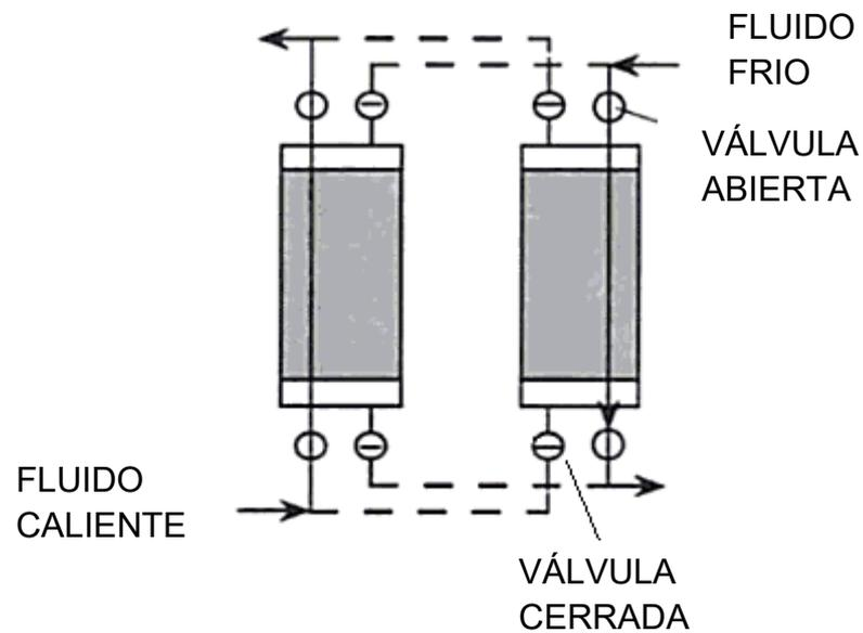
Figura 1.2. Regenerador de tipo Matrices Arregladas.<sup>1</sup>
