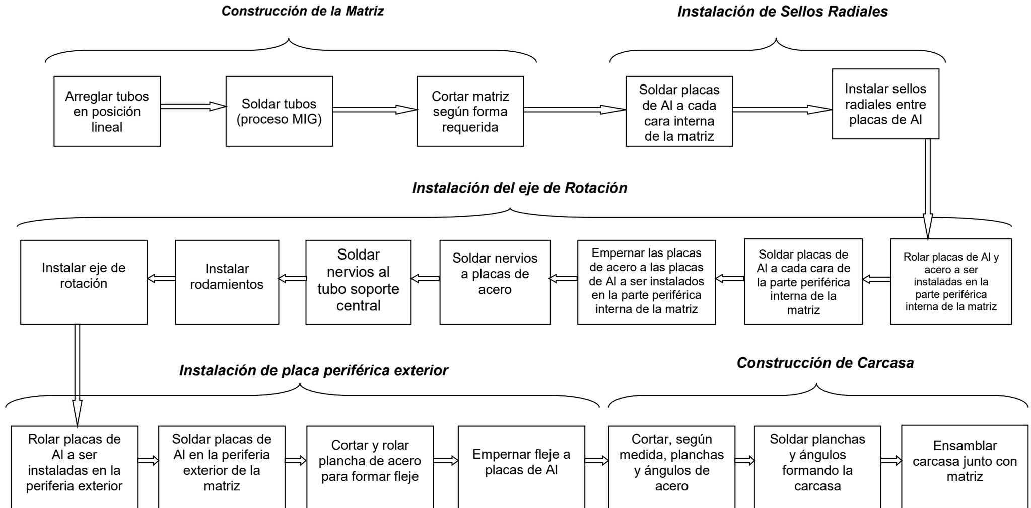
Figura 4.1. Diagrama de Flujo para Construcción del Regenerador Rotatorio
