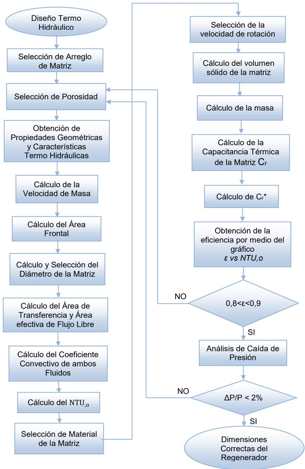
Figura 3.2. Flujo de Proceso de Diseño: Diseño Termo Hidráulico.
