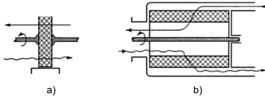
Figura 1.1. Regeneradores de tipo disco en función de su arreglo de flujo. a) Flujo Axial. b) Flujo Radial.<sup>1</sup>
