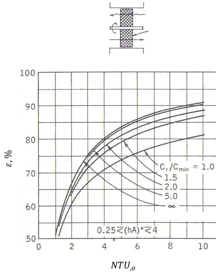
Figura 2.3. Efectividad de transferencia de calor en función del Número de Unidades de Transferencia y capacidad térmica de la matriz para  $C_{min}/C_{max} = 1,0$ .
