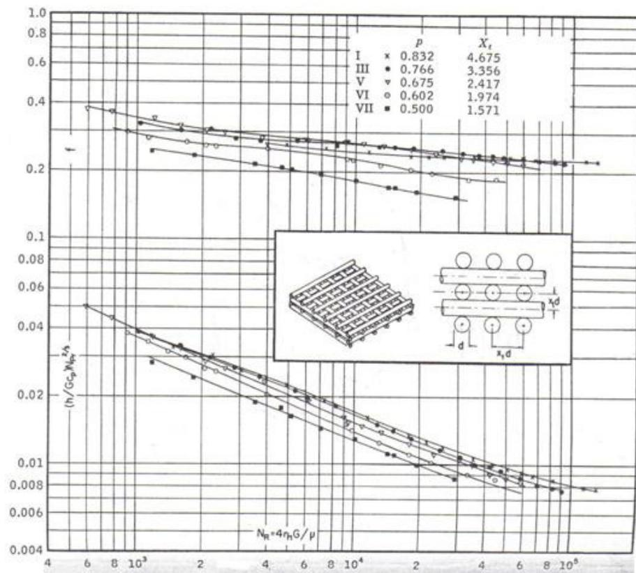
Figura 2.5. Relación entre el Factor de fricción, Número de Reynolds ( $Re$ ), número de Stanton ( $St = h/G_{cp}$ ) y número de Prandtl ( $Pr$ ) para una matriz con arreglo lineal de tubos macizos.<sup>1</sup>
