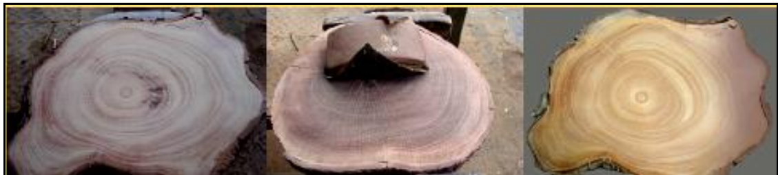
Secciones terminadas: Lijado y Pulido
