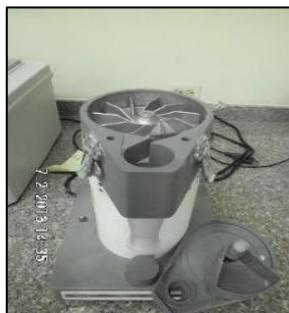
**FIGURA 3.2 CYCLONE SAMPLE MILL**
