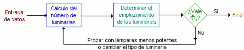
Figura 3.1.- Diagrama de bloques – método de los lúmenes.
