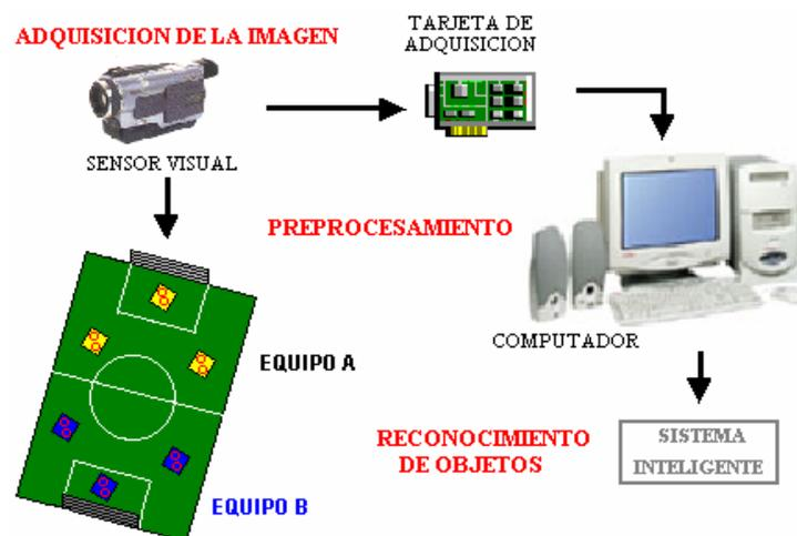
Figura 3-9. Componentes básicos de un sistema de visión.
