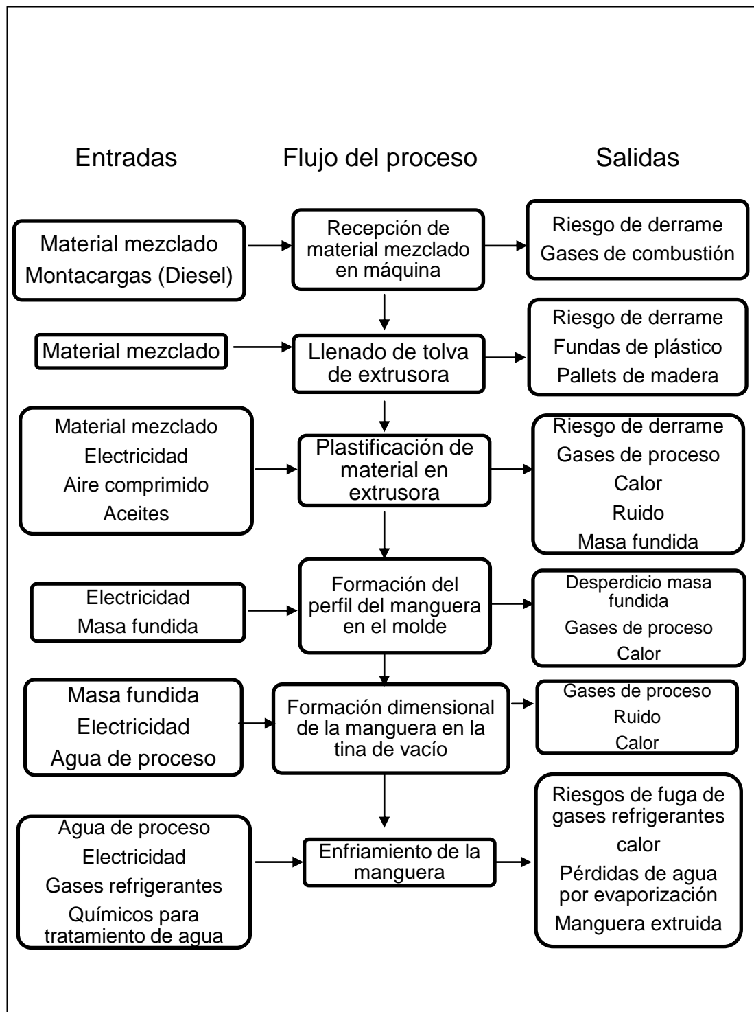
Figura 1.28 Diagrama de flujo N° 16 del proceso de mezclado de materias primas para la fabricación de manguera de polietileno
