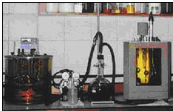
Figura 1.27 Equipo para medir Visc. Cinemática a 40°C y 100°C.
