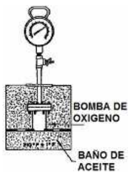
Figura 1.35 Equipo para probar la Estabilidad a la Oxidación.
