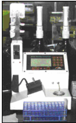
Figura 1.29 Equipo ISO 4406/1999 para Ferrografía Directa.
