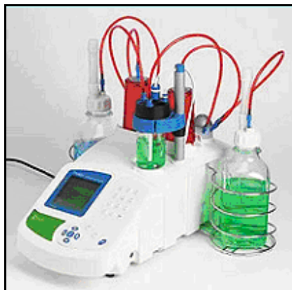
Figura 1.33 Potenciómetro para determinar el TBN.
