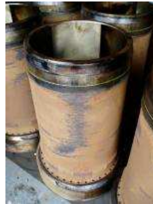
CAMISA OXIDADA POR AGUA DE REFRIGERACIÓN, GRIPADO POR ALTA TEMPERATURA Y BAJO TBN DEL ACEITE USADO
