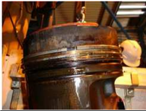
FORMACIÓN DE LACAS EN PISTÓN POR ALTA TEMPERATURA (TERMO-OXIDACIÓN)
