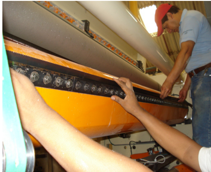
FIGURA 3.11 OPERADOR SIN EQUIPOS DE PROTECCIÓN PERSONAL
