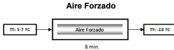
Figura 2.2. Temperaturas y Tiempo de Proceso en el Equipo de Aire Forzado
