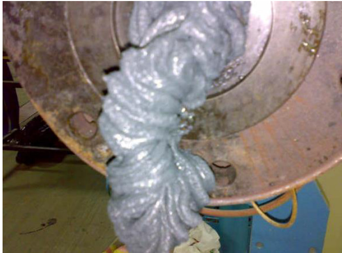
Figura 3.8 Salida de material de la extrusora.
