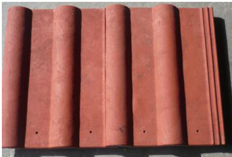
Figura 4.2 Teja compuesta a base de celulosa, aluminio y polietileno reciclado.
