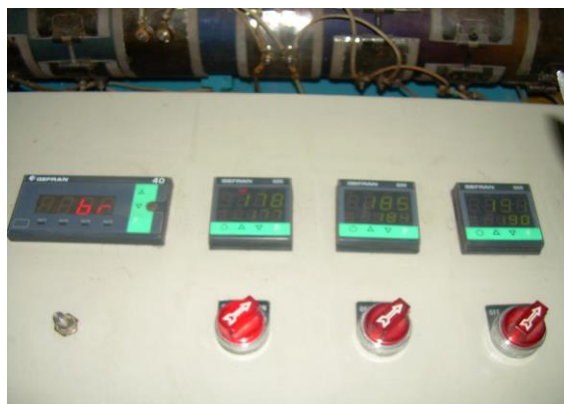
Figura 3.5 Control de temperatura de 3 secciones del barril de la extrusora.
