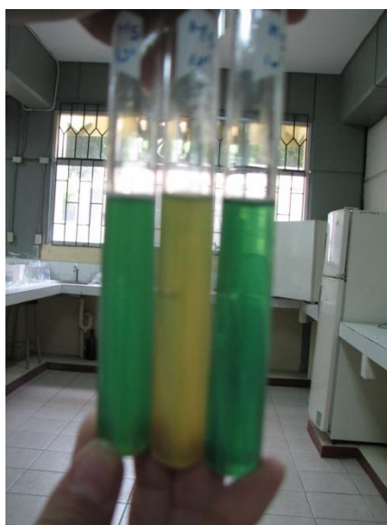
Figura 2.6. Tubos positivos (2) dilución 10^{-1} a coliformes totales en Pdcto. Final
