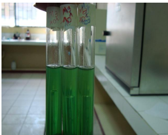
Figura 4.5 Ausencia de coliformes totales en Pdcto. Final dilución 10^{-1} a Partir de método NMP
