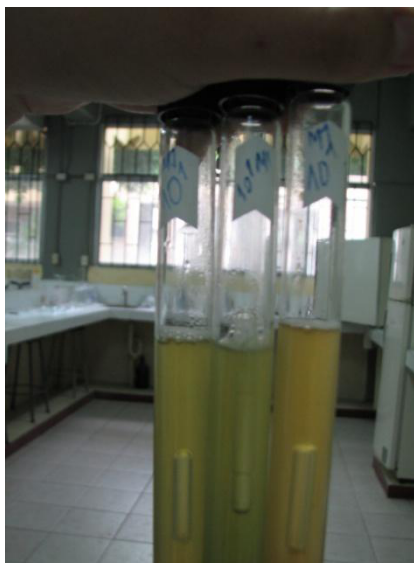
Figura 2.4. 3 tubos positivos en dilución 10^1 a coliformes totales en la etapa de Pesado
