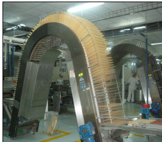
FIG. 2.3 ARCO DE ENFRIAMIENTO
