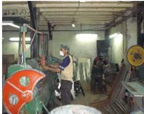
FIGURA 3.5 OPERACIÓN DE DOBLADO DE TEMPLADORES
