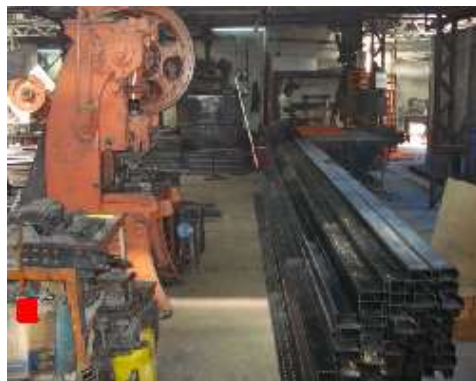
FIGURA 4.7 TARJETAS ROJAS EN ÁREA DE ALMACENAJE DE VIGAS Y MARCOS
