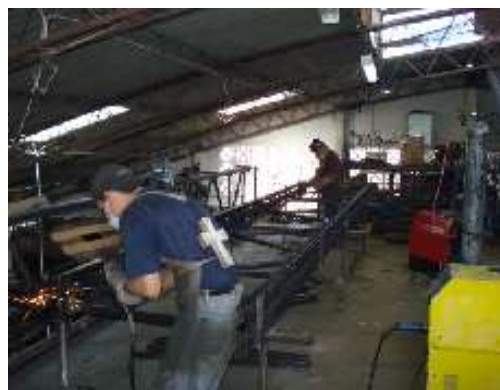
FIGURA 3.7 OPERACIÓN DE ENSAMBLE DE MARCOS
