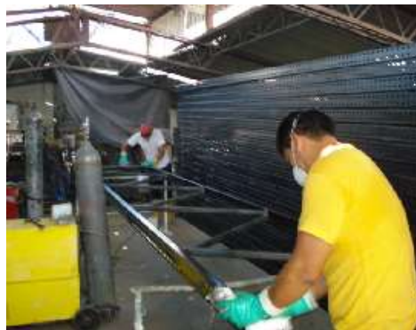
FIGURA 3.8 OPERACIÓN DE LAVADO DE MARCOS
