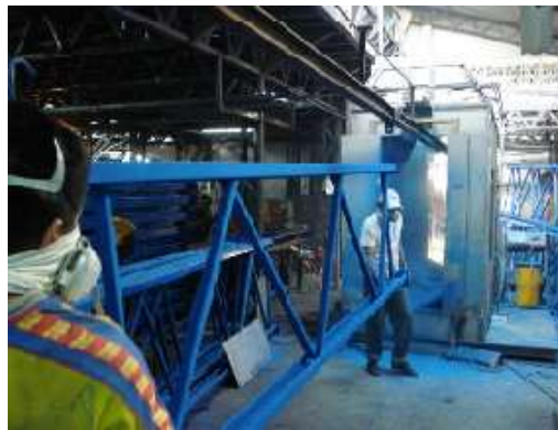
FIGURA 3.9 OPERACIÓN ROCIADO DE PINTURA EN POLVO
