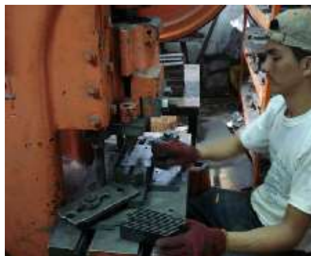
FIGURA 3.13 OPERACIÓN DE TROQUELADO Y REMACHE DE PINES
