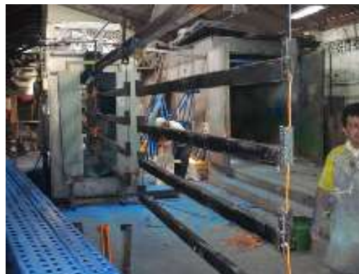
FIGURA 3.18 OPERACIÓN ROCIADO DE PINTURA A VIGAS
