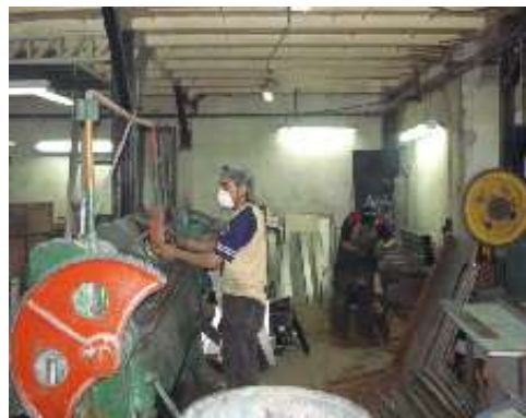
FIGURA 3.5 OPERACIÓN DE DOBLADO DE TEMPLADORES
