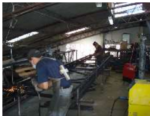
FIGURA 3.7 OPERACIÓN DE ENSAMBLE DE MARCOS
