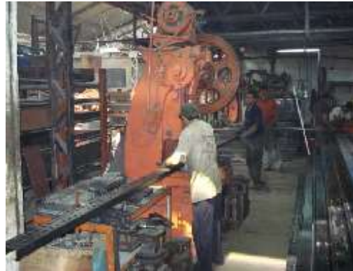
FIGURA 3.6 OPERACIÓN DE TROQUELADO DE CORREAS
