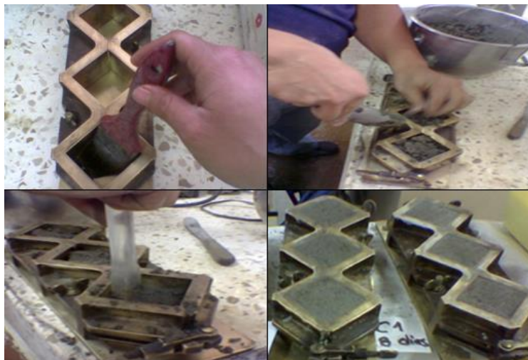
Fig. 4.16 Moldeo de morteros
