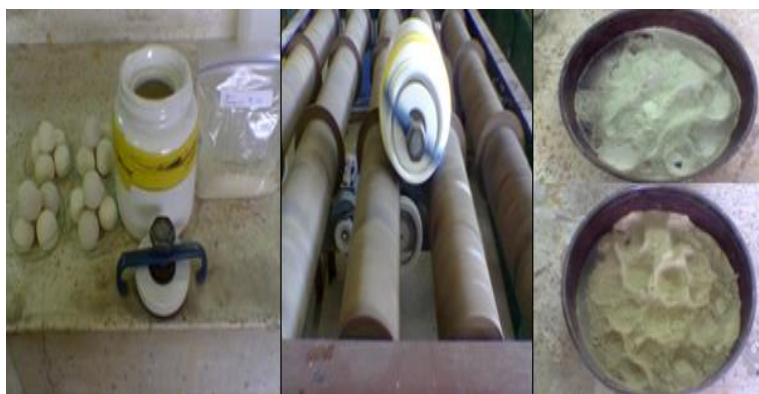
Fig. 4.10 Tratamiento de Amorfización por molienda
