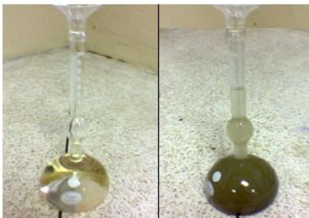
Fig. 4.6 Prueba de densidad matraz Le Chatelier
