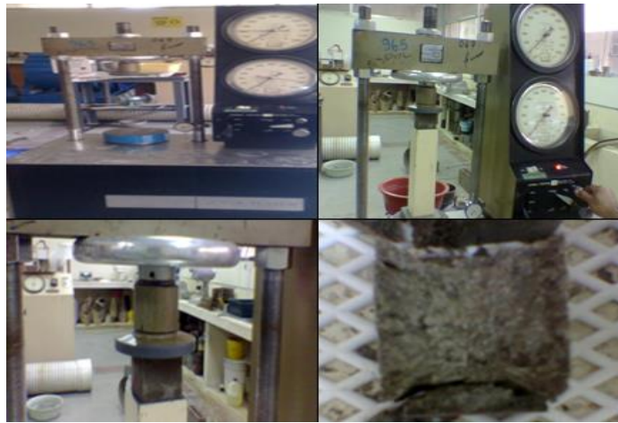
Fig. 4.18 Ruptura de cubos a los 7, 28 días
