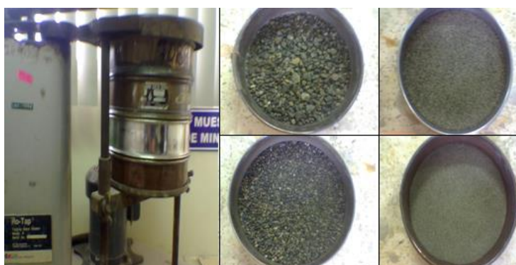
Fig. 4.12 Tamizado de Arena
