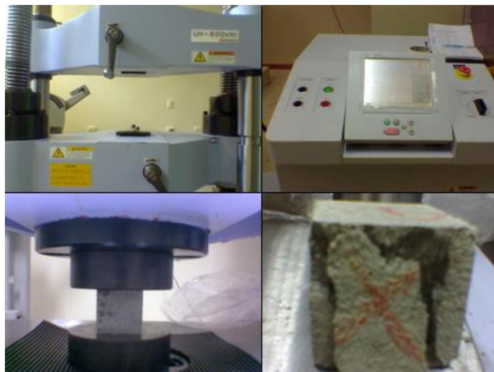
Fig. 4.19 Ruptura de cubos a los 45 días
