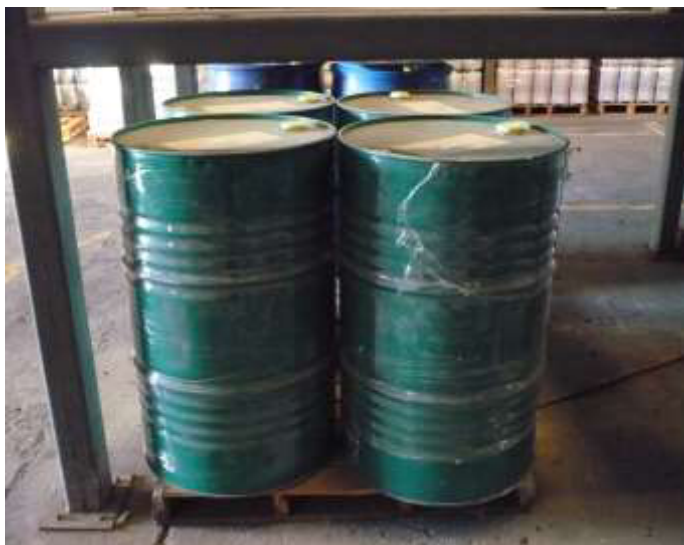
FIGURA 1.5. CARGA UNITARIA DE TAMBORES DE 55 GALONES
