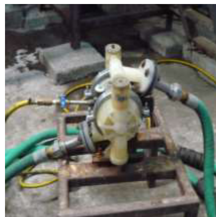
FIGURA 1.3. BOMBA NEUMÁTICA (VISTA LATERAL)
