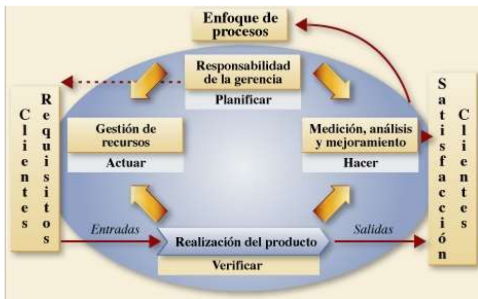
FIGURA 2.1. DIAGRAMA DE ENFOQUE DE PROCESOS APLICANDO PHVA
