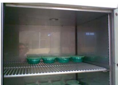
**FIGURA 4.5: INCUBACIÓN DE LAS CAJAS CON LAS ISOTERMAS A TEMPERATURA CONSTANTE 32°C**
