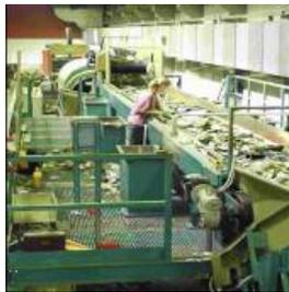
**FIGURA 2.15 CINTA DE TRANSPORTACIÓN PARA CLASIFICACIÓN Y SEPARACIÓN**
