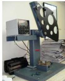
**FIGURA 4.4 MÁQUINA DE RESISTENCIA AL IMPACTO**
