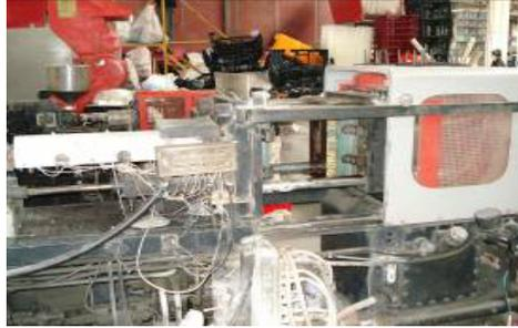
**FIGURA 2.5 MÁQUINA INYECTORA**
