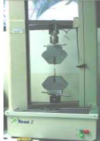
**FIGURA 4.6 MÁQUINA DE TRACCIÓN UNIVERSAL.**
