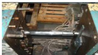
**FIGURA 3.4 MOLDE PARA PROBETAS CON EXPULSADOR**
