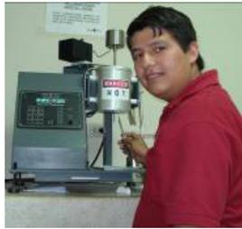
**FIGURA 3.5 PLASTÓMETRO DE EXTRUSIÓN**
