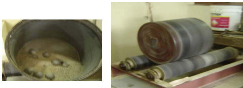
FIGURA 3.10. MOLIENDA EN EL MOLINO DE BOLAS
