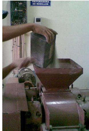
FIGURA 3.5. TRITURACIÓN DE LA ZEOLITA TIPO 2 EN LA TRITURADORA DE RODILLOS
