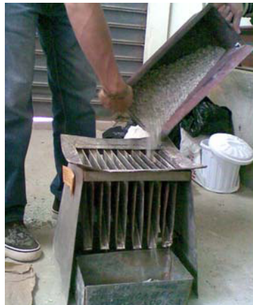
FIGURA 3.6. HOMOGENIZACIÓN DE LA ZEOLITA TIPO 2
