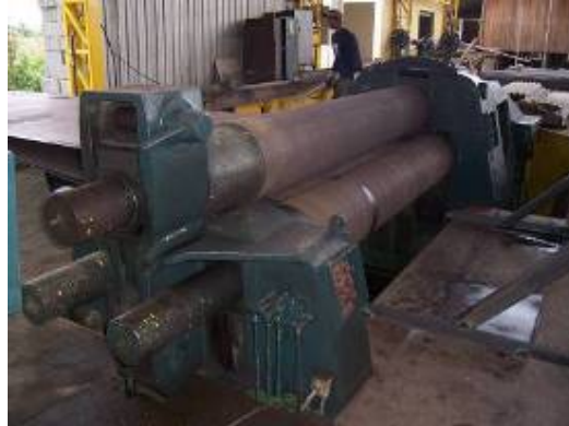
Figura 4.18 Rolado de planchas metálicas
