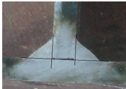
Figura 4.13 (b) Macrografía- Penetración Completa
