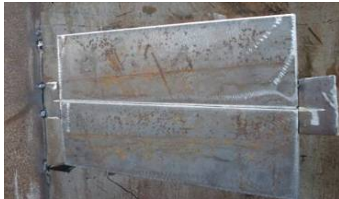
Figura 4.2 Cupón de prueba – SMAW 2G
