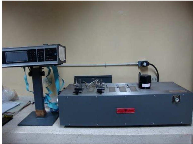
FIGURA 2.7 MÁQUINA PARA ENSAYO VICAT
