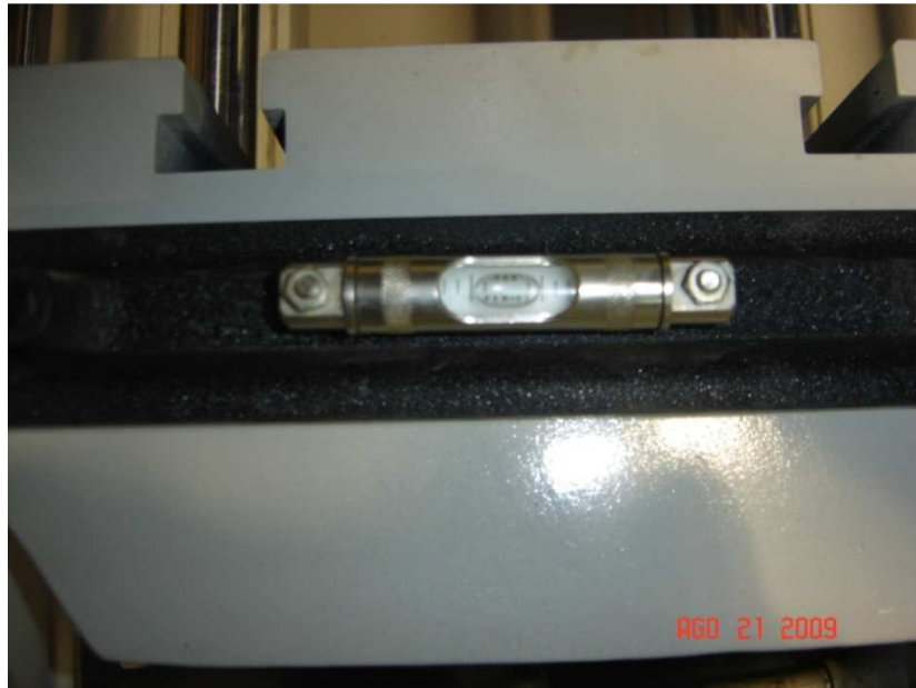
FIGURA 4.19 NIVELACION DE LA EXTRUSORA.
