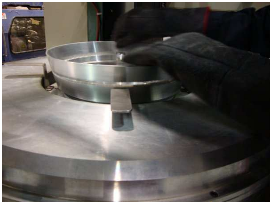
FIGURA 5.3 MONTAJE MOLDE DE EXTRUSIÓN.
