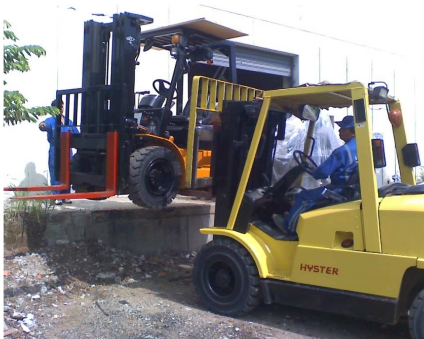
FIGURA 3.4 LEVANTADA DE MONTACARGAS DE 5 TON
