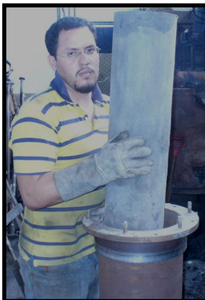
FIGURA 1.11 PREPARACIÓN DE MOLDE DE ARENA EN EL TUBO CENTRIGUGADOR
