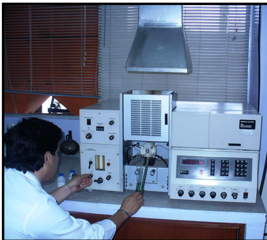
FIGURA 2.4 ESPECTROMETRO DE ABSORCIÓN ATÓMICA DE INTRAMET
