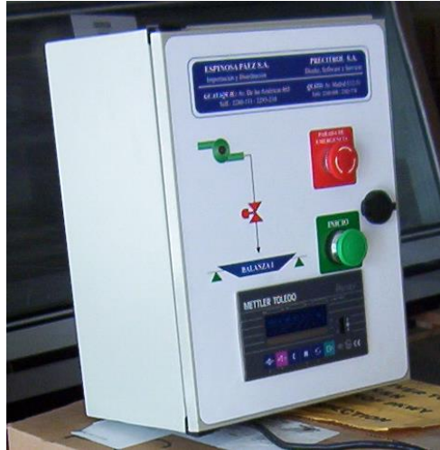
FIGURA 3.27. PANEL DE CONTROL PESAJE DE TANQUE BÁSCULA
