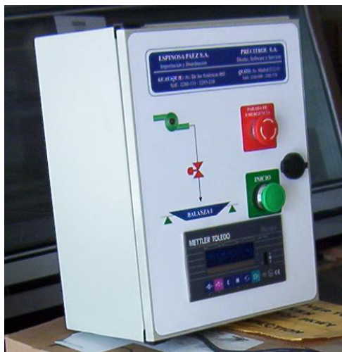
FIGURA 3.27. PANEL DE CONTROL PESAJE DE TANQUE BÁSCULA
