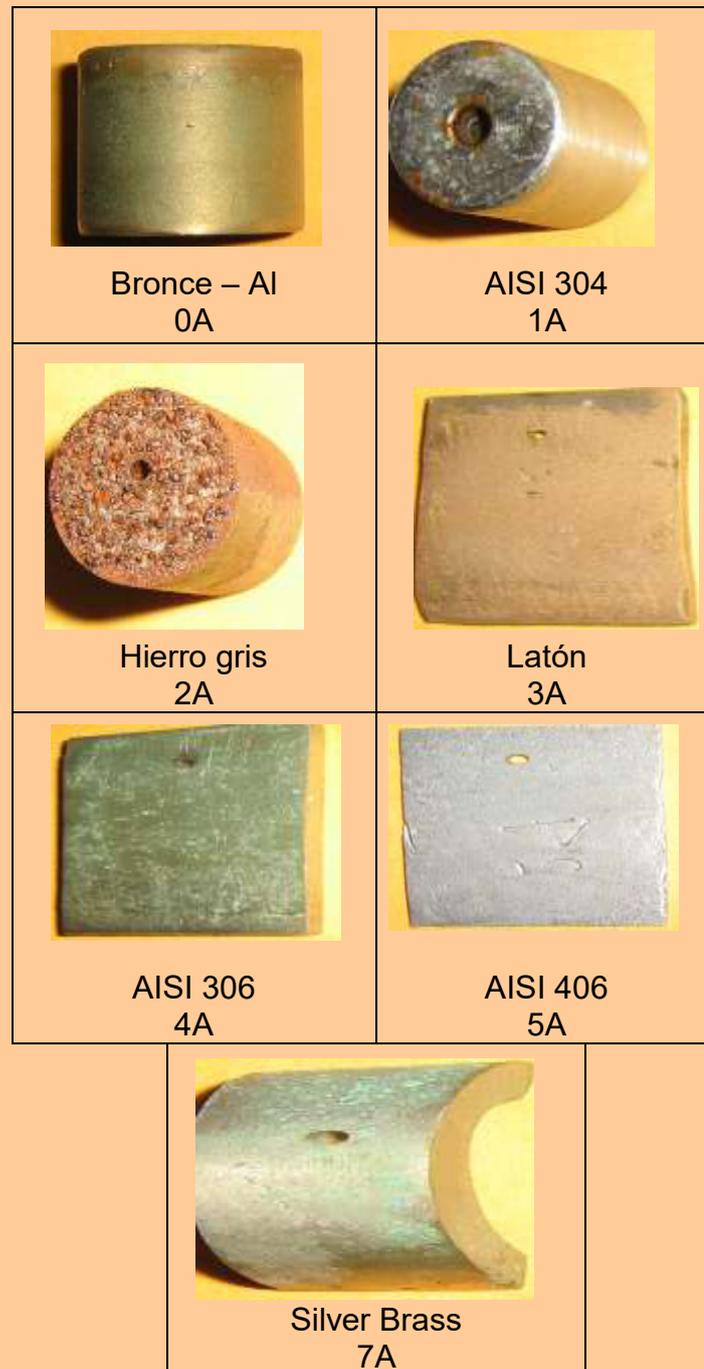
**FIGURA 2.17 MATERIALES PARA PRUEBAS DE CORROSIÓN**
