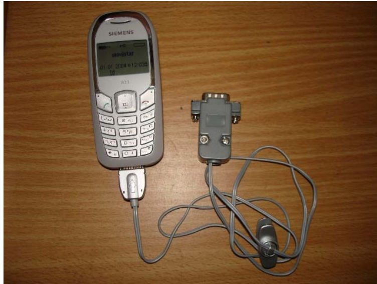
FIGURA 3.11 FOTO DEL MODULO RECEPTOR.
