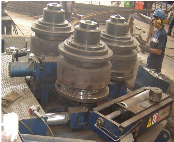
FIGURA 3.5 CURVADO DE VIGAS
