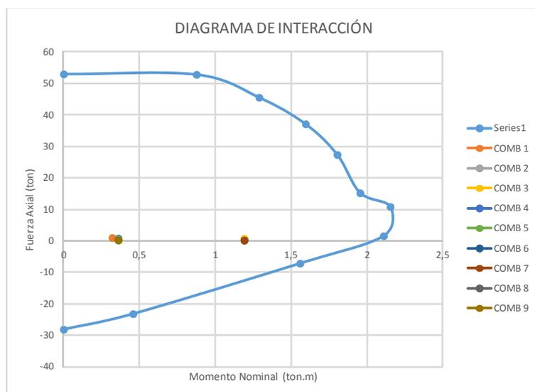
Se observa que tanto para el gráfico 3.8 como el gráfico 3.9, los puntos de momento-carga axial que demandan las combinaciones propuestas, se ubican dentro del diagrama de interacción de los elementos propuesto, por lo cual el diseño propuesto para la alternativa de hormigón armado para el refuerzo longitudinal en columnas, resulta satisfactorio para la alternativa armadura electrosoldada y se acepta el diseño, esto se debe principalmente
