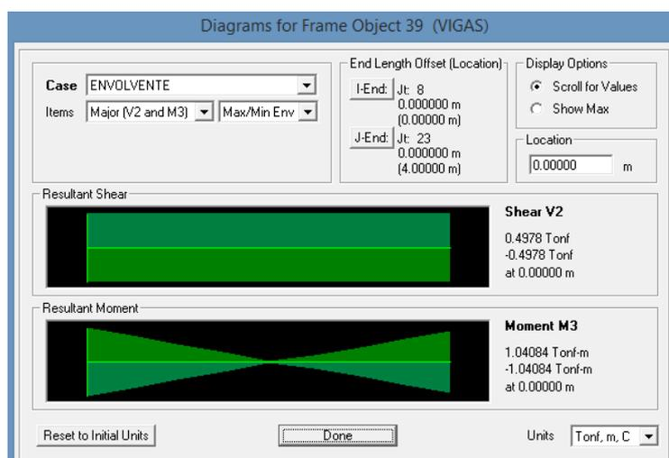
**Figura 3.4: Diagrama de momento flector y fuerza cortante de la envolvente de combinaciones correspondiente a viga A-B eje 3. Entrepiso 1.**
