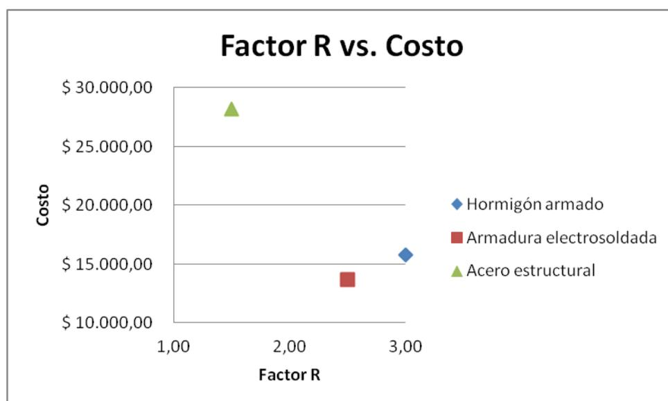
Se evidencia que el costo de la estructura de acero se ve influenciado por la disminución del factor de reducción sísmica, pues la distribución de fuerzas laterales es inversamente proporcional al factor en mención, motivo por el cual los elementos estructurales requieren una mayor dimensión para satisfacer estas demandas.
