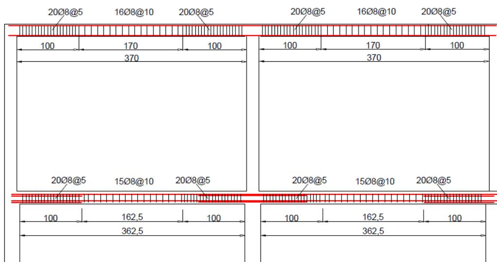
**Figura 3.12: Distribución de estribos en pórticos X**
