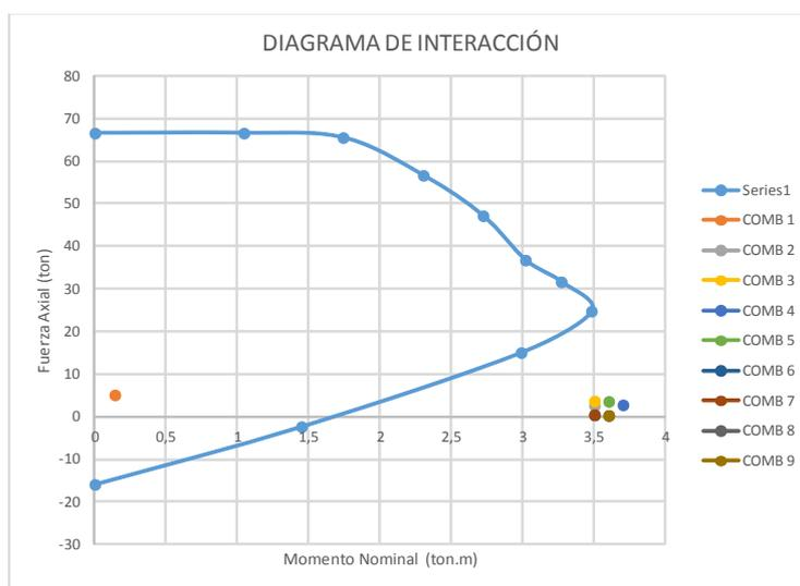
Como se puede observar, la capacidad de la columna es deficiente ante las demandas de las combinaciones de cargas propuestas, por lo tanto se propone aumentar la sección de la columna a 30 x 30 cm, razón por la cual es necesario cambiar el refuerzo para mantener la cuantía mínima
