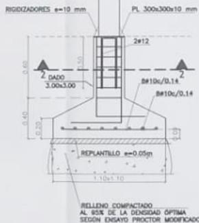
RELLENO COMPACTADO AL 95% DE LA DENSIDAD OPTIMA SEGUN ENSAYO PROCTOR MODIFICADO.
