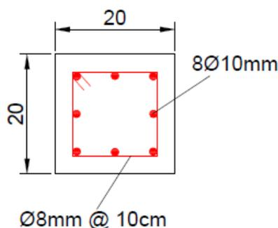
**Figura 3.16: Sección transversal de columna entrepiso 2**
