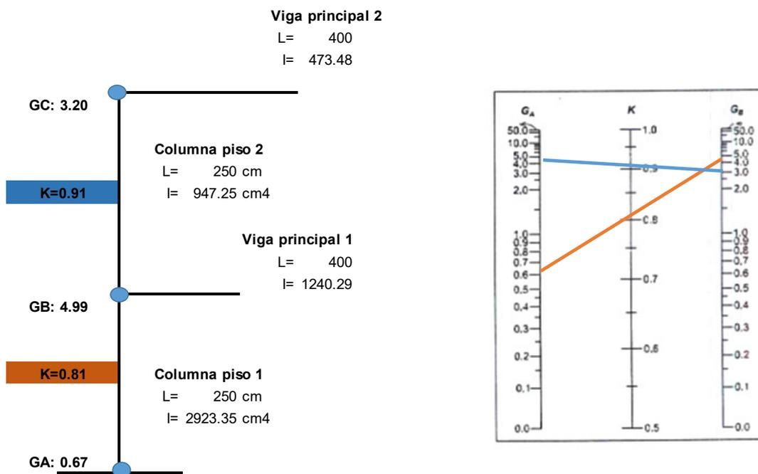
**Figura 3.23: Cálculo de K para las secciones propuestas**
