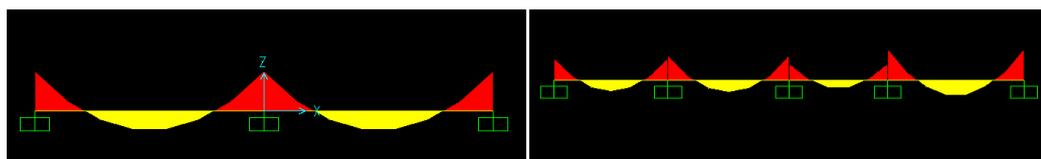
**Figura 3.29: Modelación de vigas en SAP2000 sentido 'x'; modelación de vigas en SAP2000 sentido 'y'.**
