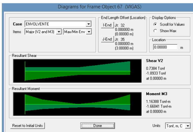
**Figura 3.5: Diagrama de momento flector y fuerza cortante de la envolvente de combinaciones correspondiente a viga 1-2 eje C. Entrepiso 1.**
