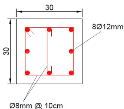
**Figura 3.15: Sección transversal de columna entrepiso 1**
