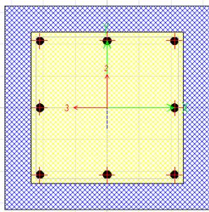
**Figura 3.14: Sección de columna entrecapota modelada en SAP2000**
