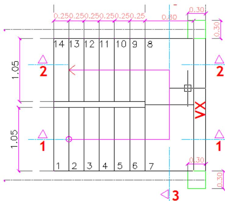
**Figura 3.18: Configuración de escaleras de la vivienda**
