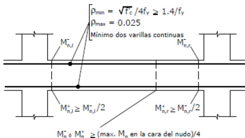
**Figura 3.9: Requisitos del refuerzo longitudinal en elementos a flexión.**
