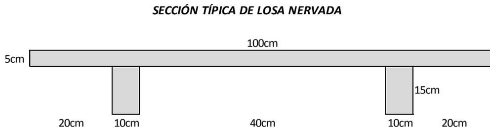
**Figura 3.17: Sección típica de losa nervada.**
