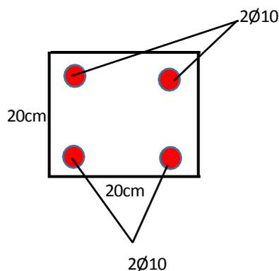
**Figura 3.8: Refuerzos longitudinales en vigas de cubierta.**
