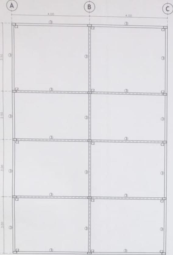
**PLANTA DE CUBIERTA: VIGAS PERIMETRALES**
