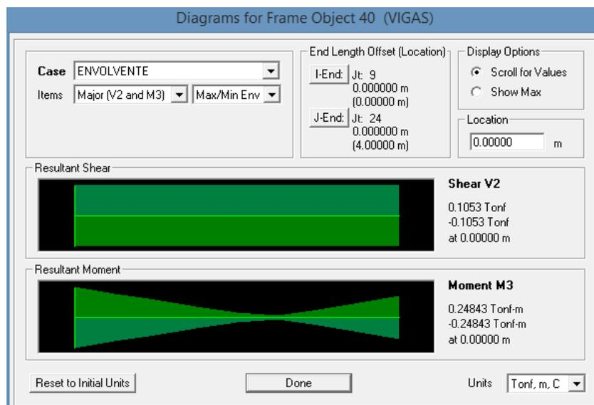
Figura 3.6: Diagrama de momento flector y fuerza cortante de la envolvente de combinaciones correspondiente a viga A-B eje 3. Cubierta.
