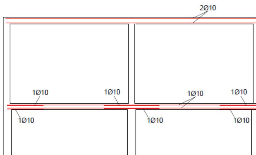
Figura 3.10: Esquema de refuerzos en pórtico X.
