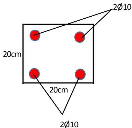
**Figura 3.30: Detalle del acero longitudinal de la viga de cimentación.**
