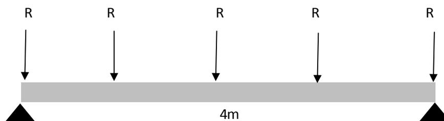
**Figura 3.33: Modelo estructural de vigas de cubierta**
