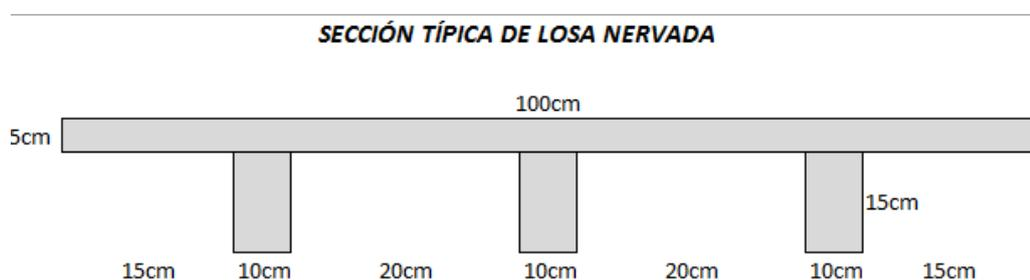
**Figura 3.1: Sección de losa hormigón armado.**
