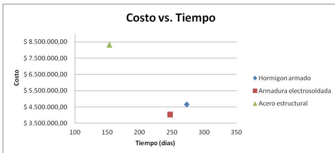
Tal como se puede observar, las alternativas de hormigón armado y armadura electrosoldada tienen un costo similar, mientras que el costo de la alternativa de acero estructural se ve duplicado.
