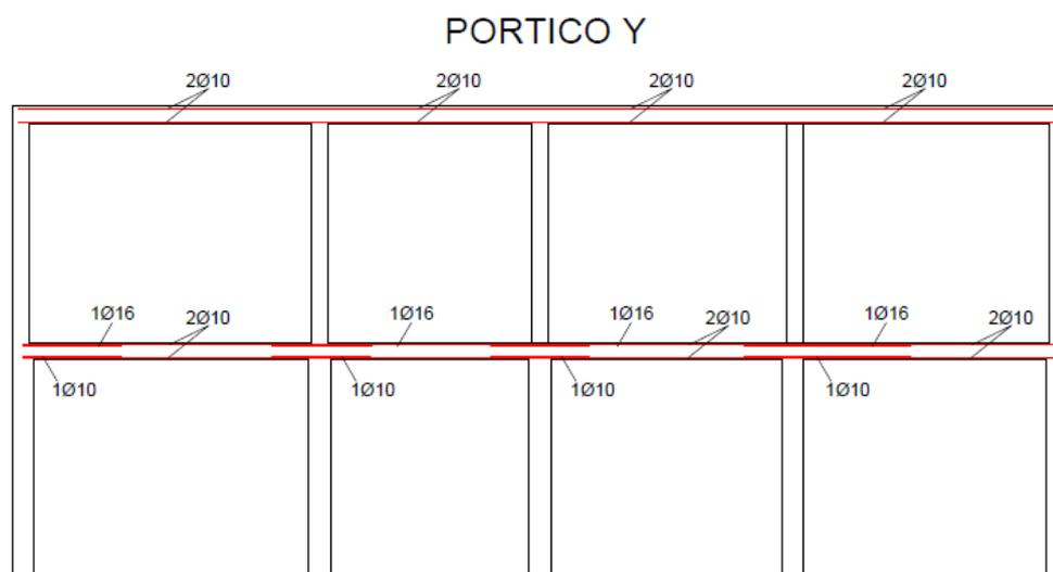
**Figura 3.11: Esquema de refuerzos en pórtico Y.**
