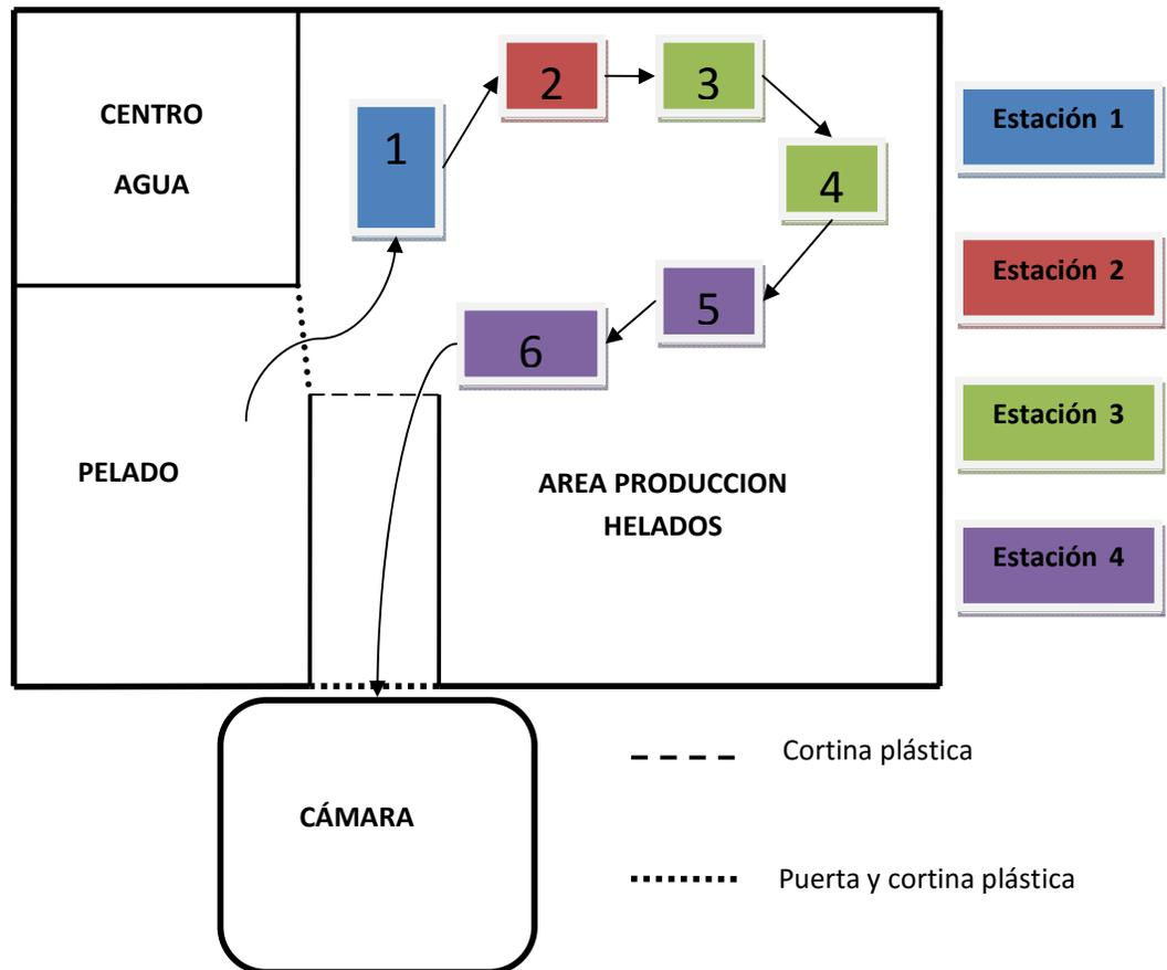
**Figura 2.7 Lay out de la nueva línea de producción**
