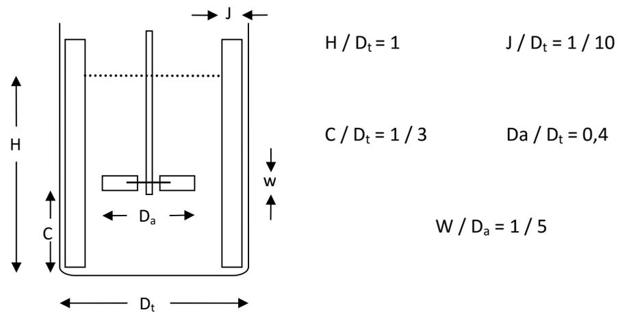
**Figura 3.12 Elementos de un tanque mezclador normal y proporciones geométricas.**
