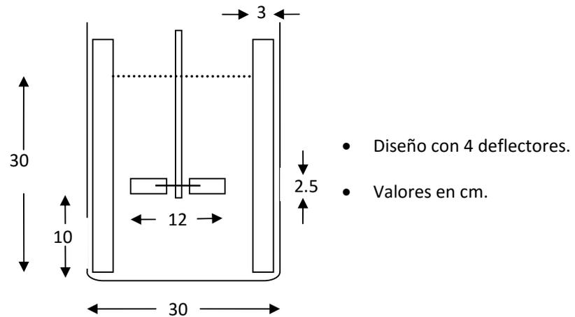
**Figura 3.13** Diseño sistema de agitación del tanque refrigerado.
