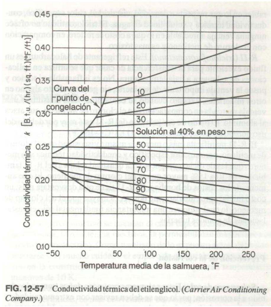
**FIG. 12-57** Conductividad térmica del etilenglicol. (*Carrier Air Conditioning Company.*)
