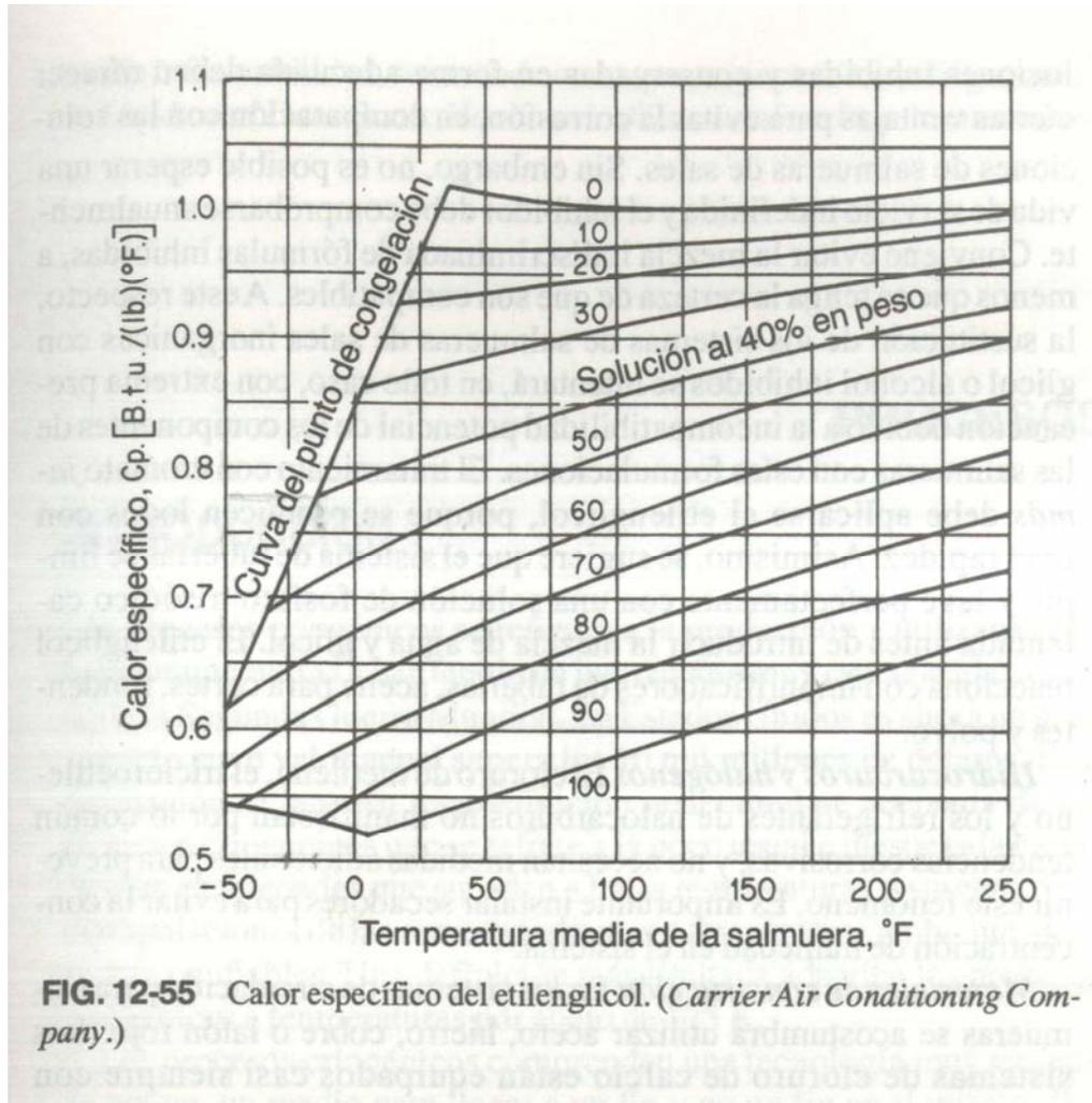
**FIG. 12-55** Calor específico del etilenglicol. (*Carrier Air Conditioning Company.*)
