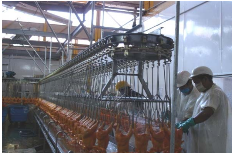
FIGURA 3.18. Operación de lavado y repasado
