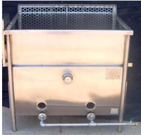
FIGURA 3.14. Máquina escaldadora de pollos.
