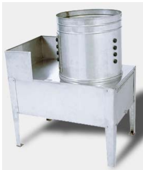
FIGURA 3.16. Máquina para el desplumado de pollos.
