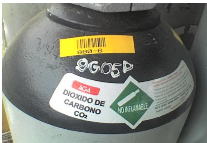
**FIGURA 3.5. CODIGO DE BARRA DE UN CILINDRO**
