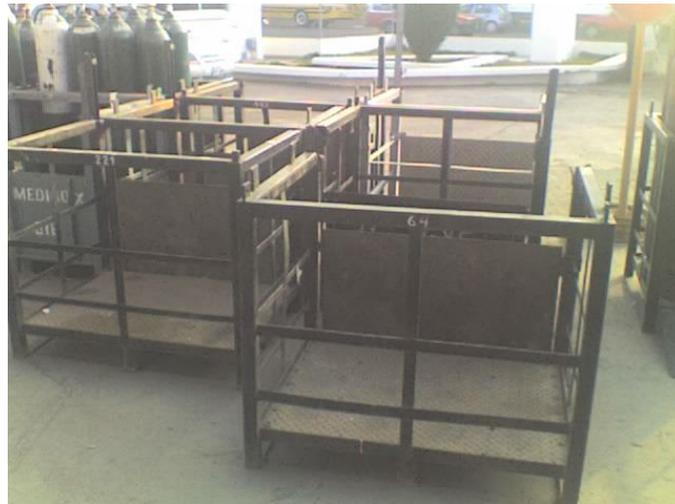
**FIGURA 3.7. CANASTILLA DE TRASLADO DE CILINDROS**
