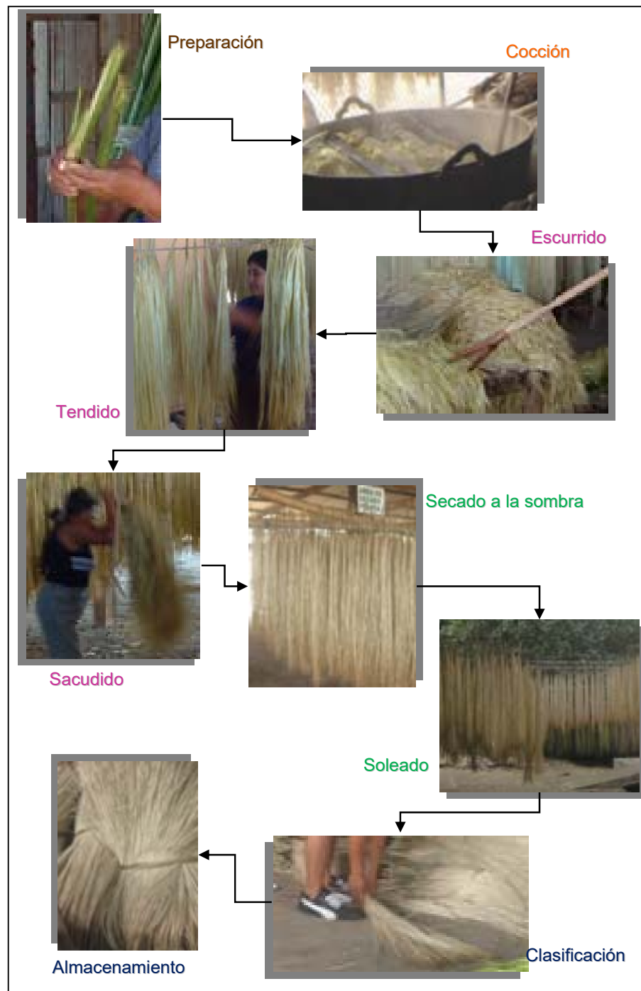
Figura 1.2. Esquema del Procesamiento de la Paja Toquilla
