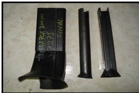
FIGURA 2.16. PRUEBAS DE ABOCARDADO – PROVEEDOR CST.
