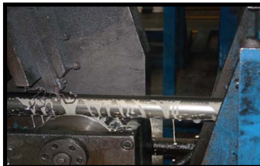
FIGURA 1.6. DESBASTE POSTERIOR A SOLDADURA.
