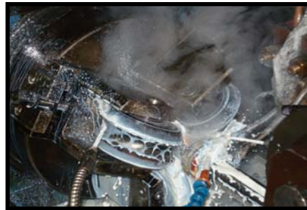
FIGURA 1.5. ÁREA CONVERGENTE EN UNA “V” HASTA TOCARSE EN LO QUE SE DENOMINA PUNTO DE SOLDADURA.
