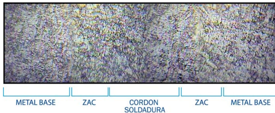
FIGURA 2.10. MICROESTRUCTURA PROVEEDOR USIMINAS 0.9 MM CÓDIGO MBF0901220 (250 X)
