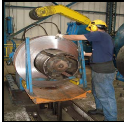
FIGURA 1.3. COLOCACIÓN DE LAS BOBINAS DE LAMINACIÓN
