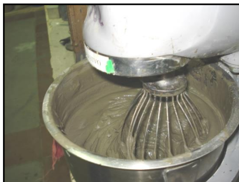
FIGURA 3.16 CEMENTO-ZEOLITA-AGUA EN LA MEZCLADORA
