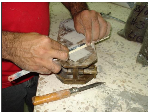
FIGURA 3.22 RETIRO DE EXCESO DE MEZCLA SECA
