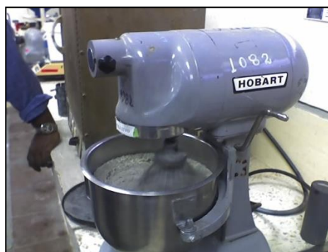
FIGURA 3.15 MEZCLA HOMOGÉNEA CEMENTO-ZEOLITA EN SECO
