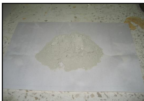
FIGURA 3.10 ZEOLITA CON GRANULOMETRÍA FINAL 45 µm
