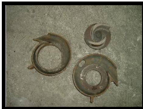
FIGURA 2.9 PREPARACIÓN DE MODELOS PARA CONSTRUIR MOLDES.
