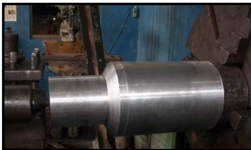
FIGURA 2.7 RODILLO DE LAMINADOR EN CONSTRUCCIÓN
