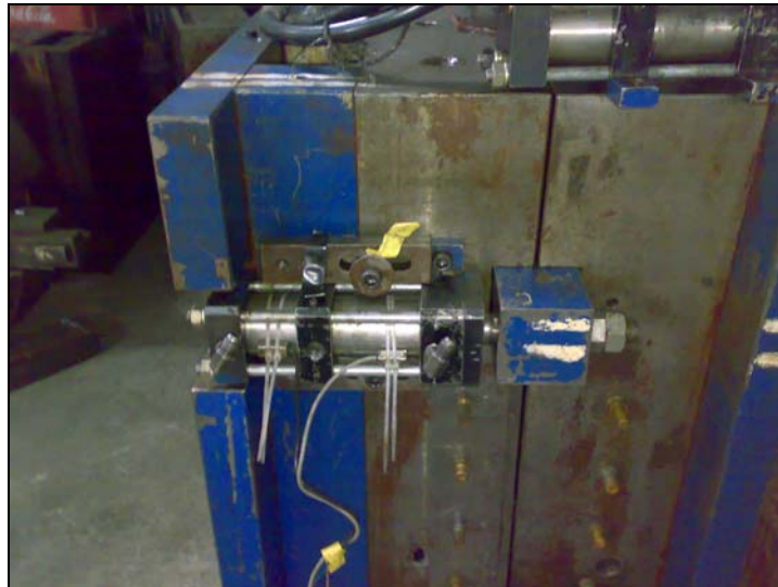
FIGURA 4.2. BOTELLA OLEO HIDRÁULICA DEL MOLDE
