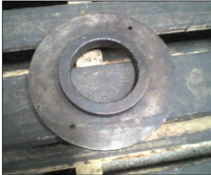
FIGURA 4.10. PLACA O DISCO AJUSTADOR AL ANILLO DE CENTRO
