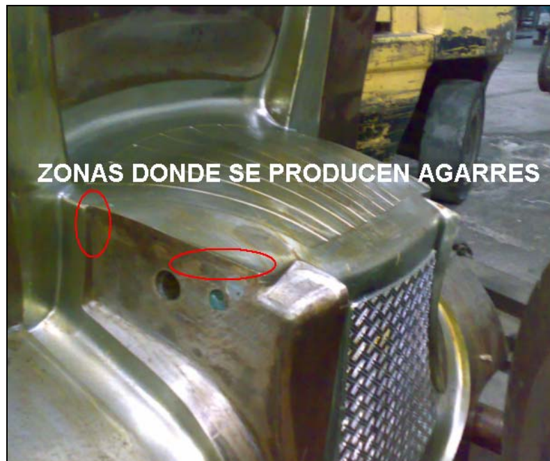
FIGURA 4.3. MOLDE CON DAÑOS POR AGARRE
