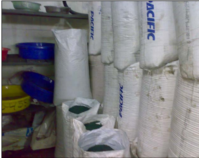
FIGURA 4.6. APILACIÓN DE SACOS SIN RECUBRIMIENTO
