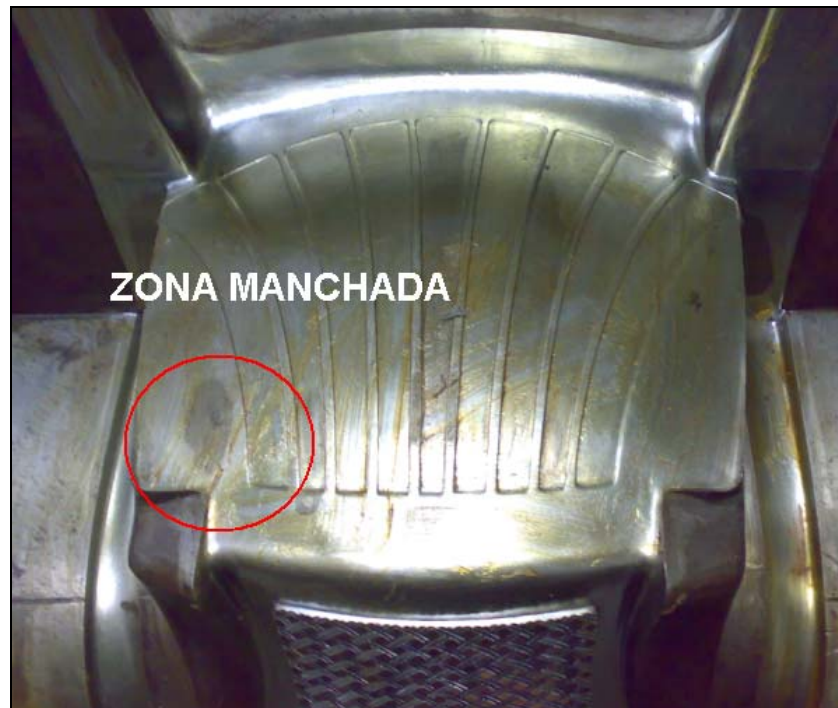
FIGURA 4.5. MANCHA DE MOLDE POR AGUA
