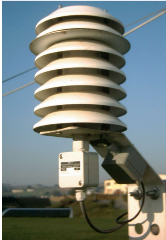
FIGURA 4.7 ESCUDO ANTI-RADIACIÓN PARA SENSOR DE TEMPERATURA
