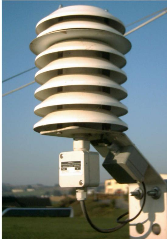
FIGURA 4.7 ESCUDO ANTI-RADIACIÓN PARA SENSOR DE TEMPERATURA
