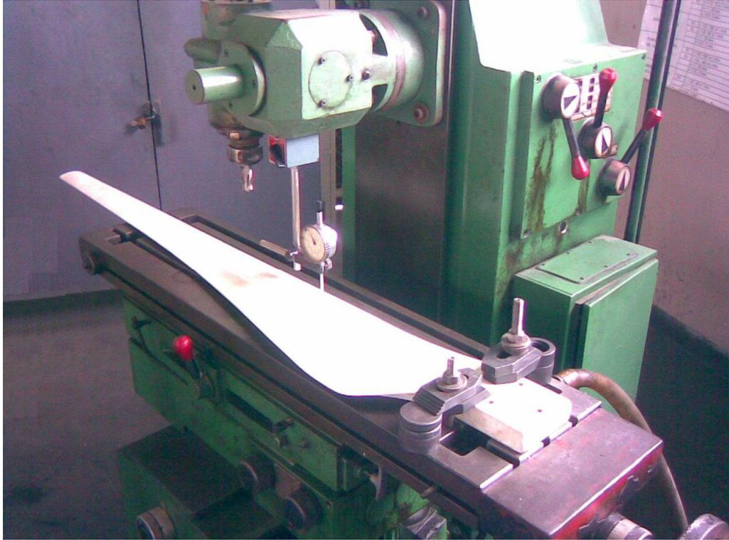
FIGURA 3.2 MEDICIÓN DE COORDENADAS EN FRESADORA
