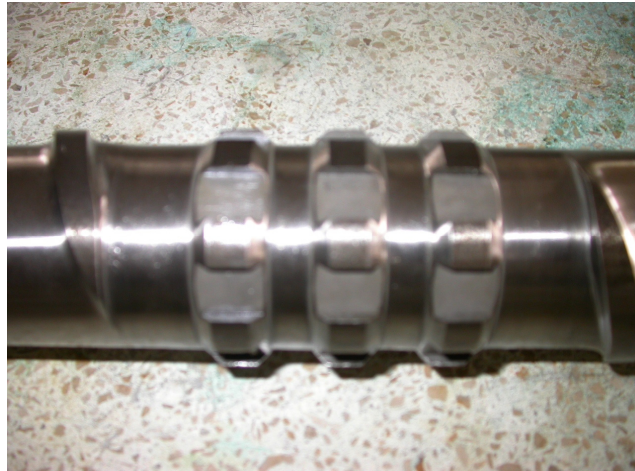
FIGURA 2.17 MEZCLADOR DISPERSIVO DE ANILLOS SELECCIONADO PARA EL HUSILLO DE LA EXTRUSORA FIMCP-ESPOL
