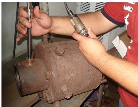
FIGURA 3.4 SENSOR DE PRESION DURANTE SU INSTALACION
