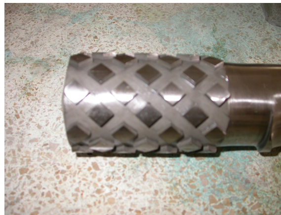
FIGURA 2.18 MEZCLADOR DISPERSIVO DE ANILLOS SELECCIONADO PARA EL HUSILLO DE LA EXTRUSORA FIMCP-ESPOL
