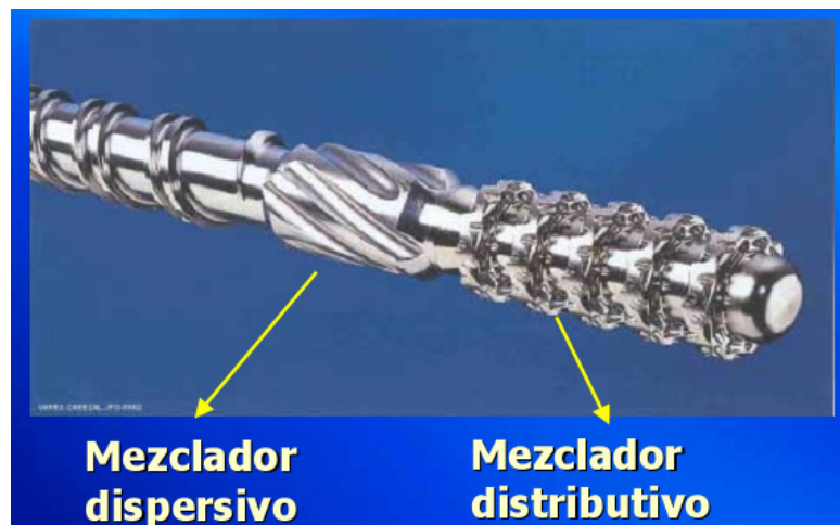
FIGURA 2.15 COMBINACIÓN DE MEZCLADORES EN UN HUSILLO DE ALTA CAPACIDAD DE MEZCLADO
