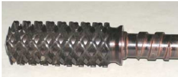
FIGURA 2.13 MEZCLADOR DISTRIBUTIVO DE ROMBOIDES
