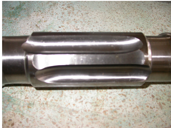
FIGURA 2.16 MEZCLADOR DISPERSIVO MADDOX SELECCIONADO PARA EL HUSILLO DE LA EXTRUSORA FIMCP-ESPOL
