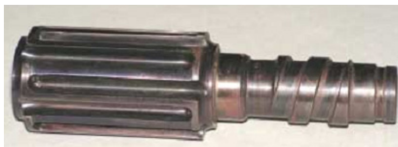
FIGURA 2.14 MEZCLADOR DISPERSIVO MADDOX O LEROY
