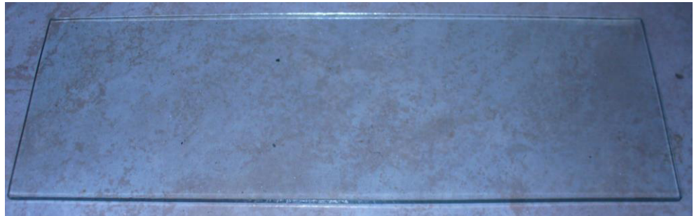
FIGURA 2.12. PROBETA DE VIDRIO NO TEMPLADO USADO EN LA APLICACIÓN DE LA PINTURA REFRACTARIA PARA PROBAR SU TENSIÓN SUPERFICIAL
