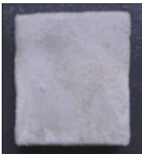
FIGURA 2.13. PROBETA ORTOÉDRICA DE EPS RECUBIERTA CON PINTURA SECA
