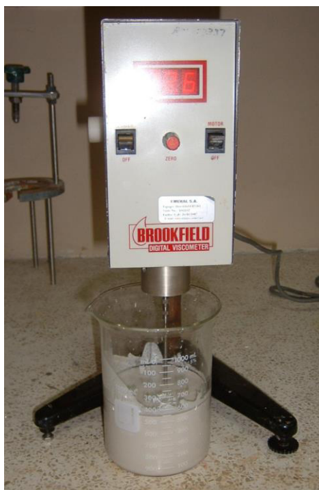
FIGURA 2.7. VISCOSÍMETRO DE MARCA BROOKFIELD® MIDIENDO VISCOSIDAD DINÁMICA O ABSOLUTA DE LA PINTURA REFRACTARIA
