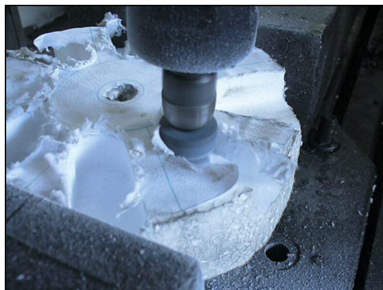
FIGURA 2.9. MECANIZACIÓN DEL PATRÓN DE ESPUMA DE POLIESTIRENO
