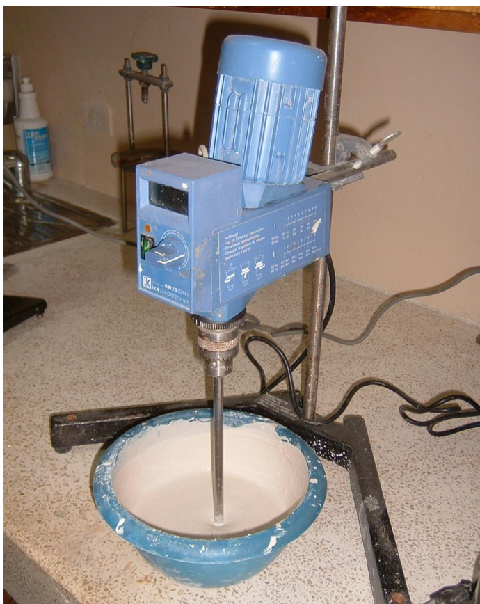
FIGURA 2.6. AGITADOR MECÁNICO-ELÉCTRICO TRABAJANDO A 200 RPM
