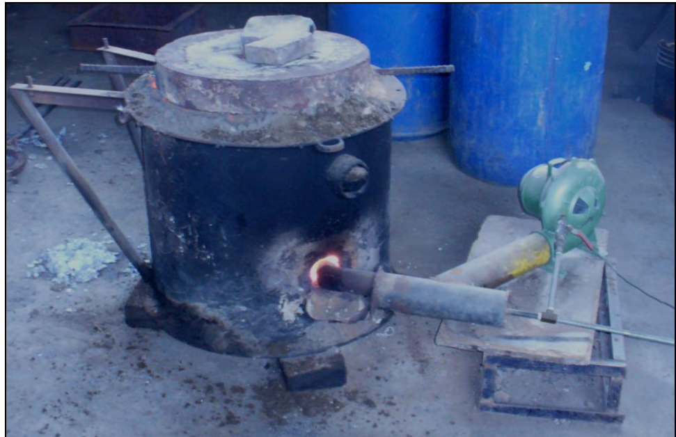
FIGURA 2.16. HORNO PARA FUNDICIÓN DE METALES NO FERROSOS CON GAS LICUADO DE PETRÓLEO (GLP) COMO COMBUSTIBLE
