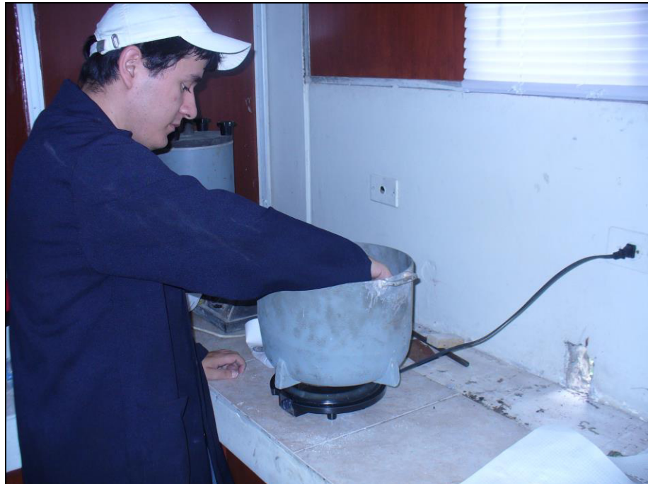
FIGURA 2.15. MOMENTO DE LA APLICACIÓN DE LA PINTURA REFRACTARIA SOBRE EL MODELO DE IMPULSOR HECHO EN EPS (INMERSIÓN)
