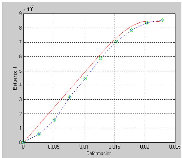
FIGURA 4.27 VALIDACIÓN DEL MODELO A LOS 21 DÍAS
