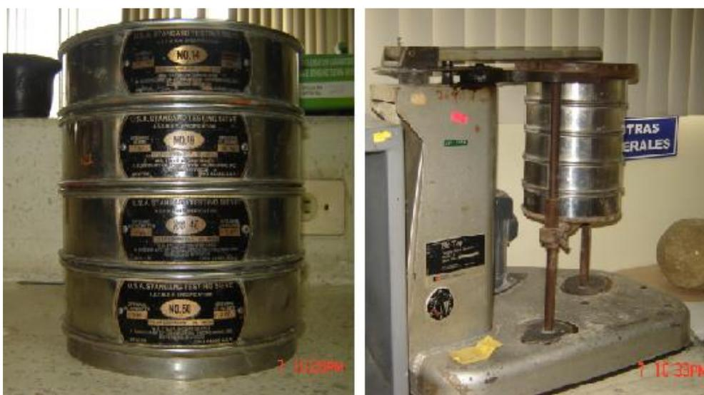
FIG 3.3 TAMICES Y TAMIZADOR ELECTRICO
