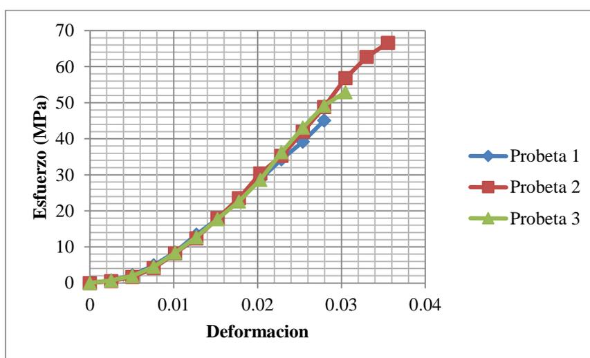
FIGURA 4.2 GRAFICA ESFUERZO – DEFORMACIÓN (G3/10/14)
