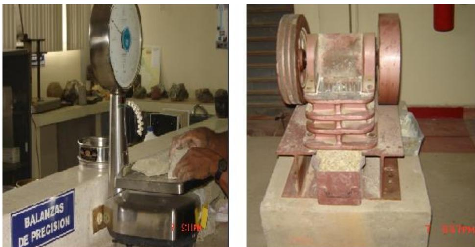
FIG 3.1 PESAJE Y TRITURADORA DE MANDÍBULAS
