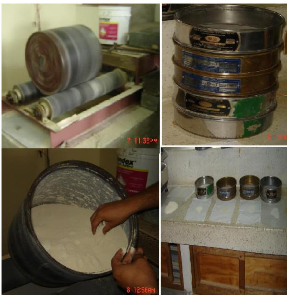
FIG 3.5 MOLINO DE BOLAS Y TAMICES
