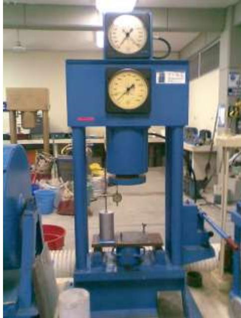
MAQUINAS UTILIZADAS PARA LOS ENSAYOS DE COMPRESIÓN
