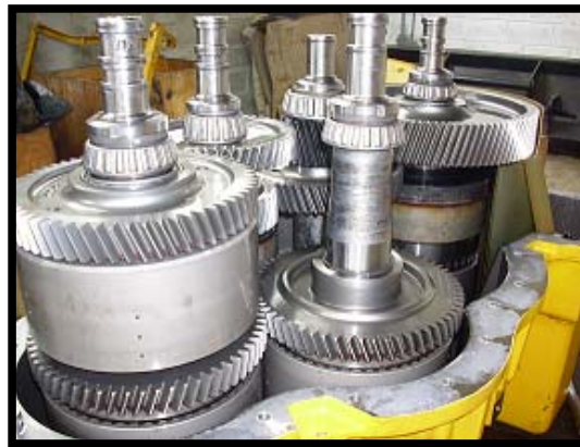
FIGURA 1.8 TRANSMISIÓN DESMONTADA Y DESCUBIERTA LA CARCASA.
