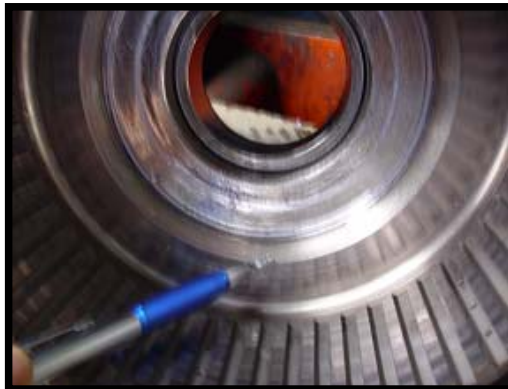
FIGURA 1.10 DESGASTE EN EL INTERIOR DE LA BASE DENTADA.
