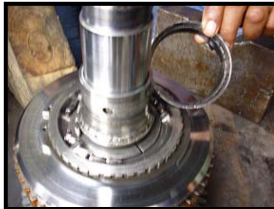
FIGURA 1.9 DAÑOS EN RODAMIENTOS PROTECTORES DE ÁRBOLES.
