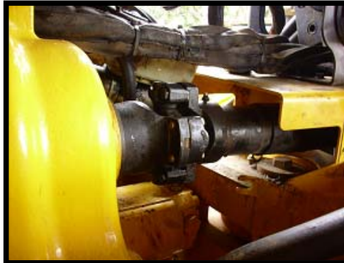
FIGURA 1.13 ACOPLAMIENTO DEL CARDAN CON LA BRIDA DE LA TRANSMISIÓN.
