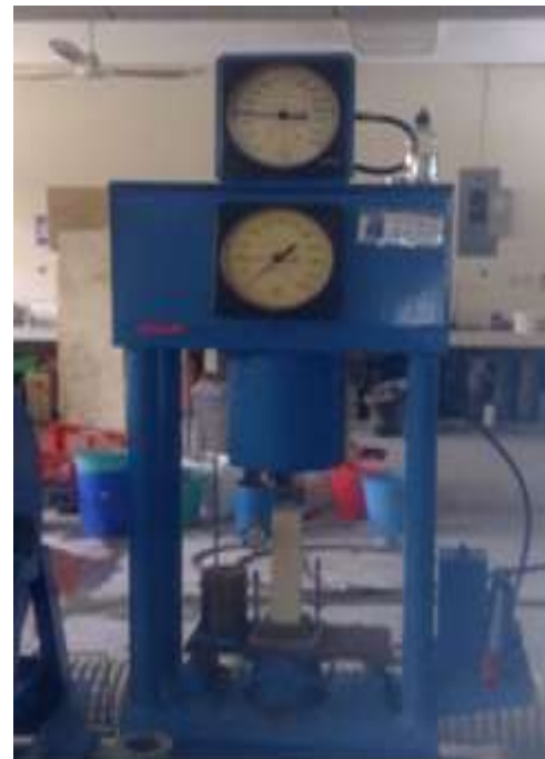
Figura 3.6. Máquinas de ensayos universales Modelos: Versa Tester AP 1020 y CT-900 Norma ASTM C-39
