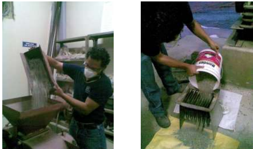
Figura 3.9. Agregado del material molino de rodillo y cuarteado de la zeolita
